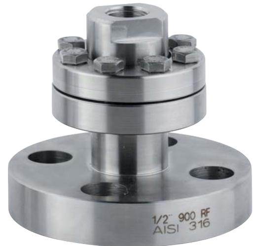
Utilisés pour isoler l'élément sensible des manomètres, pressostats et transmetteurs électroniques de pression, des fluides de process corrosifs, visqueux, sédimenteux ou d'une température élevée. Une membrane élastique serrée mécaniquement et testée, garantit la séparation du fluide de transmission de celui du process. L'étanchéité métallique de la membrane permet l'utilisation du séparateur avec de hautes températures en prévenant que les joints en soient affectés.
